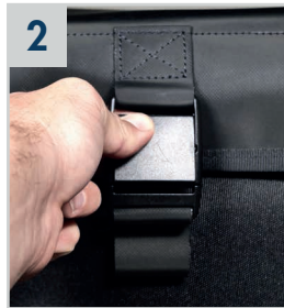
2 Druck ausüben auf die obere glatte Fläche des Clips / Apply a pressure on the upper flat part of the clip
